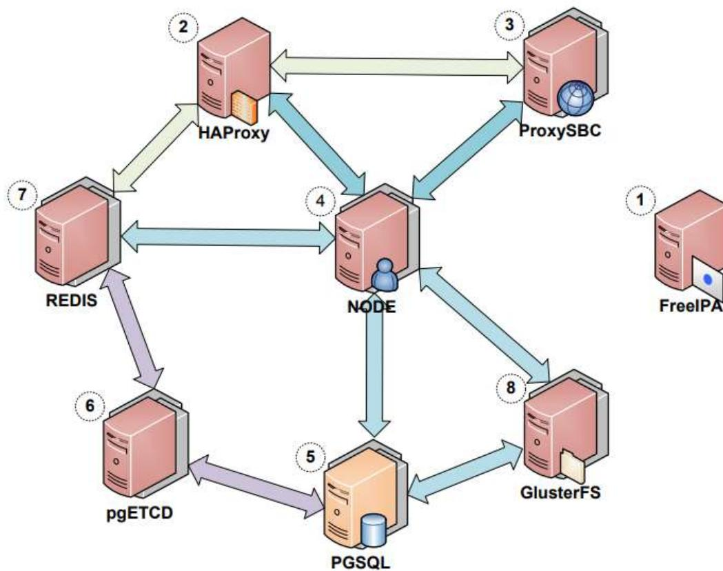
Также возможно многокластерное развертывание Платформы согласно Рисунку 2:
